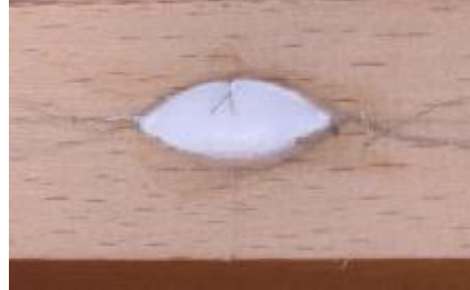
Resim 2.6: a,b,c: Sedef parçalarının yuvasına tutkallanarak yerleştirilmesi
