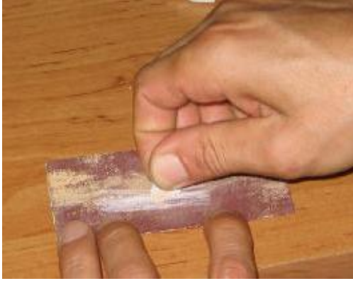
Resim 1.16.a,b: Zımpara kâğıdı kullanılarak sedefin şekillendirilmesi
