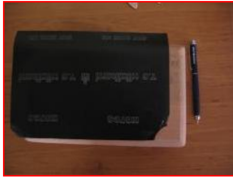
Resim 1.9: Kutu üzerine karbon kâğıdının yerleştirilmesi
