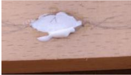
Resim 2.6: a,b,c: Sedef parçalarının yuvasına tutkallanarak yerleştirilmesi
