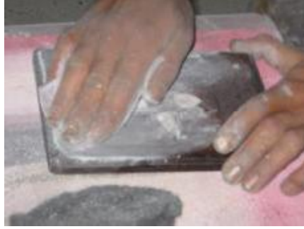
Resim 2.15: Dolgu verniğinin elle zımparalanması
