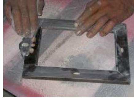
Resim 3.14: Çerçeveye dolgu verniği uygulaması Resim 3.15: Dolgu verniğinin zımparalanması
