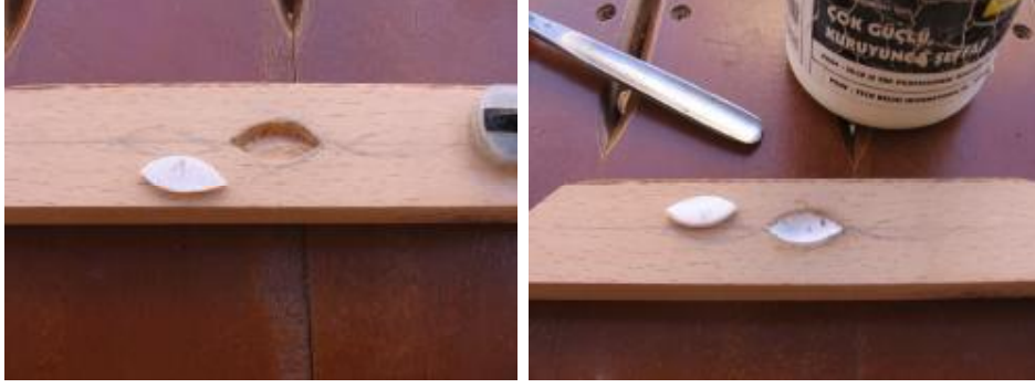
Resim 3.7.a,b: Sedef yuvasının tutkallanması
