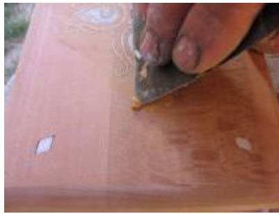
Resim 2.8: a,b,c: Sedf motifi boşluklarının macunla doldurulması
