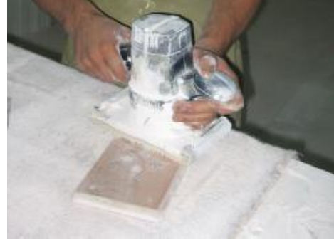
Resim 2.10: Titreşimli makine ile zımparalama
