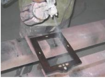
Resim 3.14: Çerçeveye dolgu verniği uygulaması Resim 3.15: Dolgu verniğinin zımparalanması
