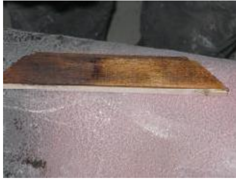
Resim 3.10: Renk açma ve koyulaştırma
