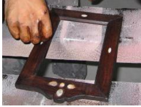
Resim 3.13: Sedef üzerine bulaşan Osmanlı eskitmenin silinmesi
