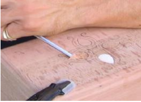
Resim 2.3 a,b,c,d: Sedef yuvalarının oyulması ve sedeflerin yerlerine alıştırılması
