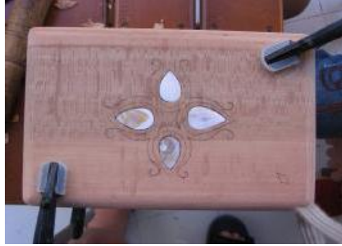
Resim 2.3 a,b,c,d: Sedef yuvalarının oyulması ve sedeflerin yerlerine alıştırılması
