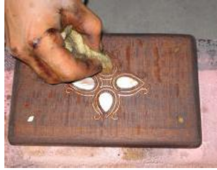
Resim 2.13: Sedef üzerindeki boyanın silinmesi
