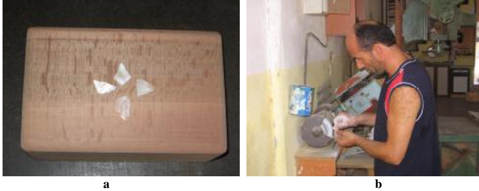
Resim 1.14.a,b: Sedef parçalarının zımpara taşı kullanılarak şekillendirilmesi
