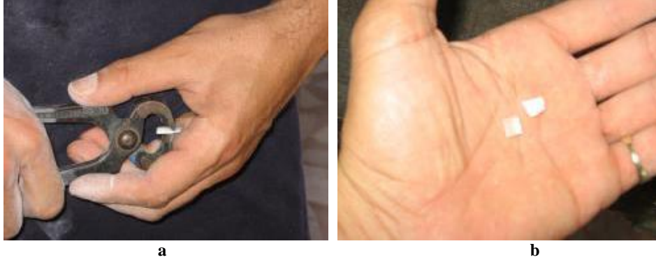
Resim 1.13.a,b: Sedef parçalarının kerpeten ile kesilmesi
