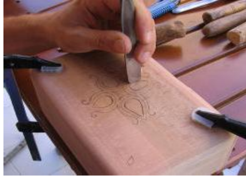
Resim 2.2: Motif hatlarının kesilmesi
