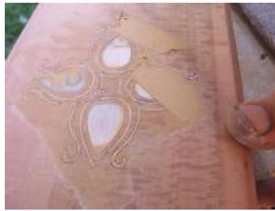
Resim 2.8: a,b,c: Sedf motifi boşluklarının macunla doldurulması
