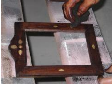
Resim 3.12: Çerçeveye Osmanlı eskitme sürülmesi
