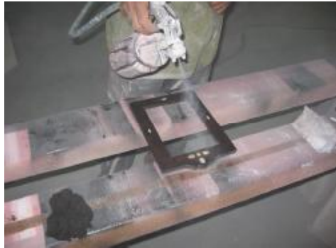
Resim 3.16: Çerçeveye mat vernik uygulaması
