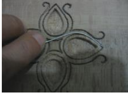
Resim 2.5: Telin, tel yuvasına yerleştirilmesi
