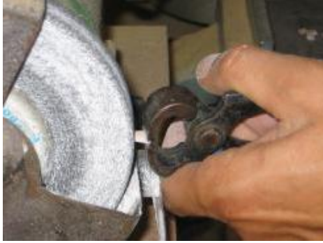
Resim 1.15.a,b: Zımpara taşında şekillendirilmiş sedef parçaları
