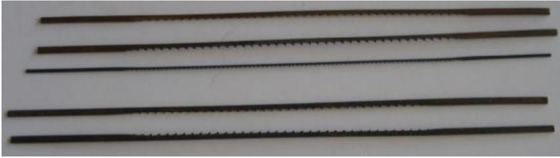
Resim 1.10: Farklı kalınlıktaki kıl testereler
