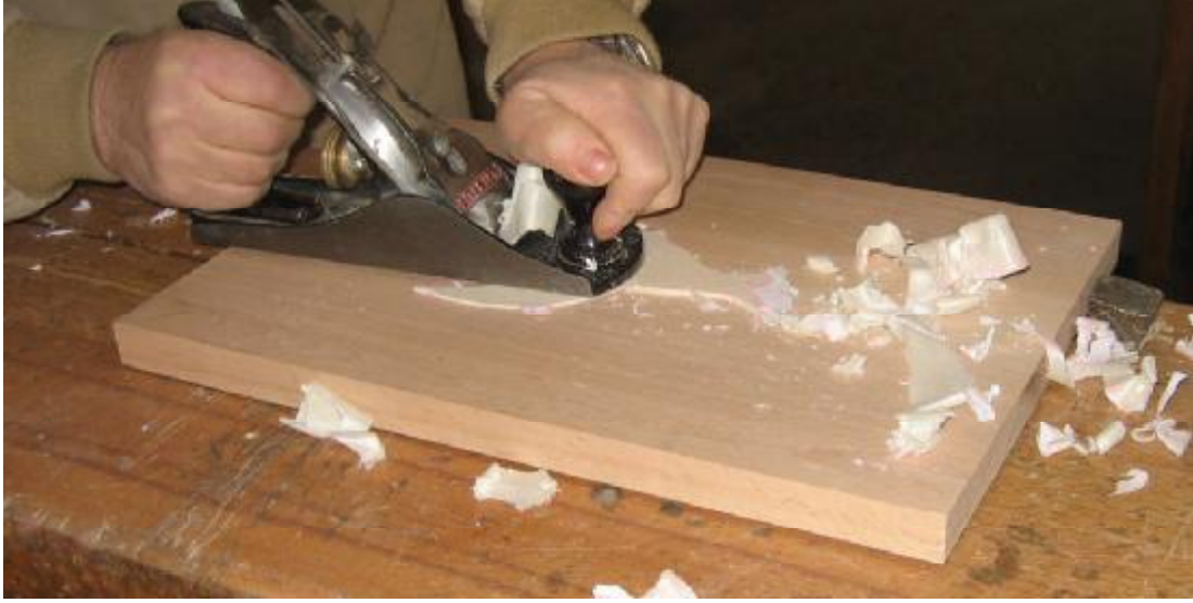
Resim 2.7: Kakma parçasındaki fazlalıkların rendelenmesi
