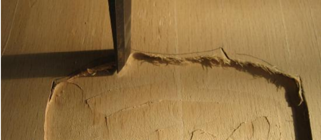
Resim 2.4: Makinede boşaltılan kenarların düzeltilmesi
