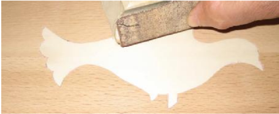
Resim 1.6: Elyaf yönünde yapılmış masif kakma
