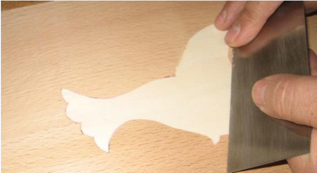
Resim 2.8: Kakma ve fon parçasının sistrelenmesi
