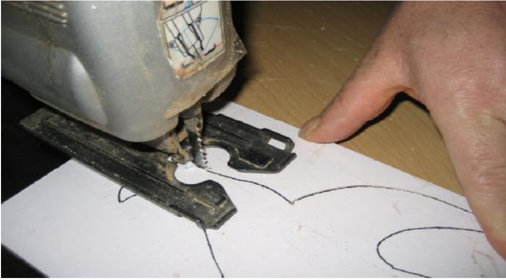
Resim 1.17: El dekupaj makinesiyle kesim yapma
